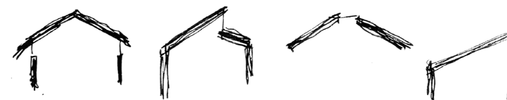
Schéma des types de toitures possibles : double pente, double avec ched, double avec un puit de lumière, monopente, ... De nombreuses solutions sont possibles mais cela risque également d'augmenter la complexité de la construction.
